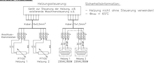
\*: Zum Anschluss der Klemmleisten Kupplung (Kupp12GFK 0-4071) entfernen!
